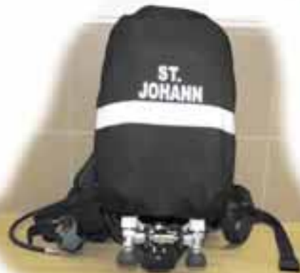
6 Stk. Übergangsst. auf Twinpak 2x 300 Bar ( Einsatzzeit ca. 90 min. )
